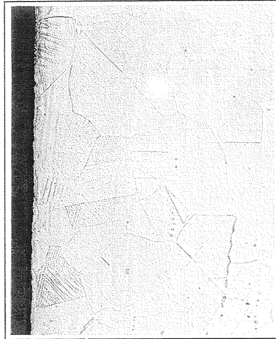
Figuur 3: Deformatiediepte (80 \mu m) in AISI 304L na schuren tot Grit P320 met lamellenborstel (V=200x).
