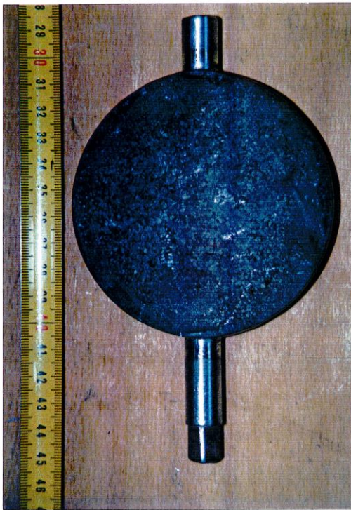
Figuur 1: Aanzicht van de vlinderklep met aantasting V = 0,5 x
