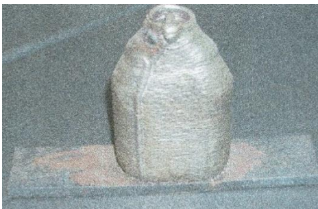
Vormgevend gelaste veldfles (TNO, 1994); MIG/MAG-gelast met een robot
